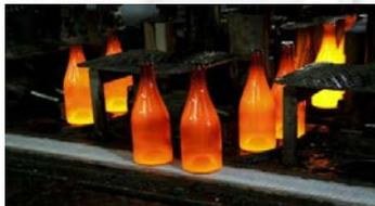
La matière collectée suit alors une chaîne qui va permettre dans un premier temps de la débarrasser de ses impuretés, comme les étiquettes ou les bouchons. Elle est ensuite lavée, puis broyée. La poudre ainsi obtenue est appelée du calcin. Ce dernier est alors fondu à une température d'environ 1 000°C pour permettre de fabriquer de nouveaux emballages en verre grâce à des moules.
